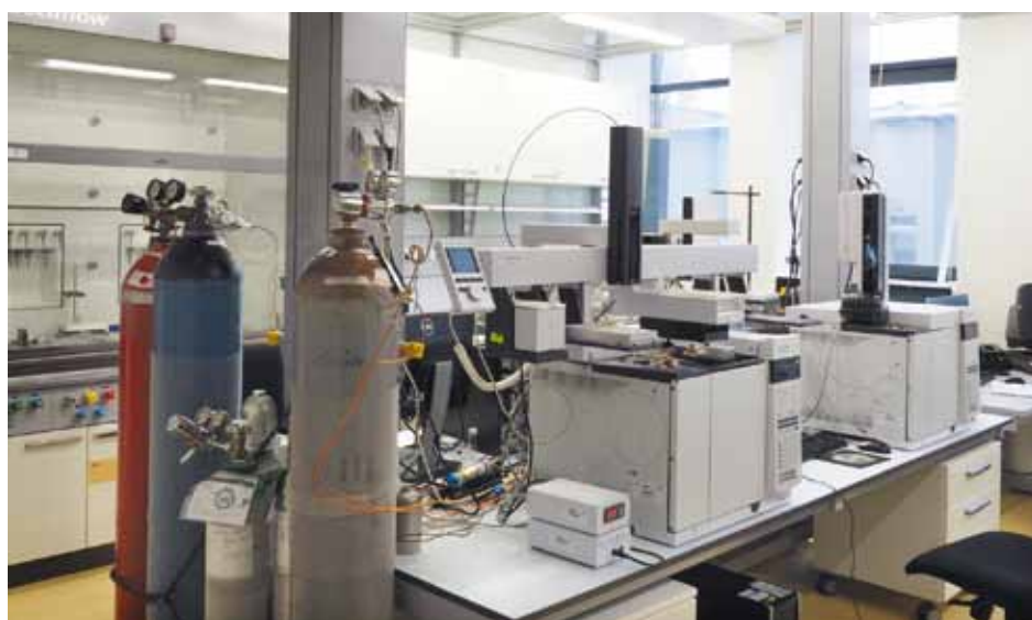
Rys. 1.9. Chromatografy gazowe, widok ogólny (fot. ORLEN Asphalt sp. z o.o. dzięki uprzejmości UniCRE)
