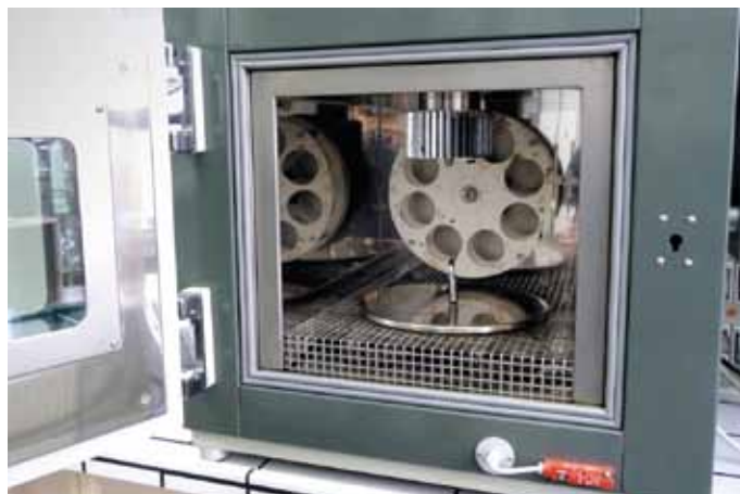
Rys. 3.35. Widok ogólny suszarki do przeprowadzania testu starzenia technologicznego RTFOT (fot. ORLEN Asphalt sp. z o.o. dzięki uprzejmości ORLEN Laboratorium sp. z o.o.)
