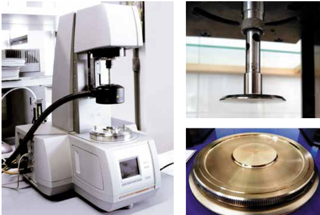
Rys. 6.1. Reometr DSR oraz układ płytek równoległych stosowanych do badania MSCR (fot. ORLEN Asphalt dzięki uprzejmości ORLEN Laboratorium sp. z o.o.)
