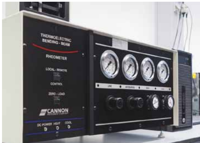
Rys.4.1. Reometr zginanej belki BBR (fot. ORLEN Asphalt sp. z o.o. dzięki uprzejmości laboratorium UniCRE)
